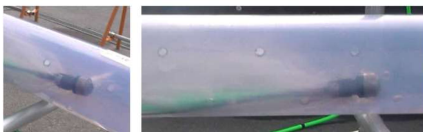
添付 5-4(4) 図 管内清掃装置進行時の様子
