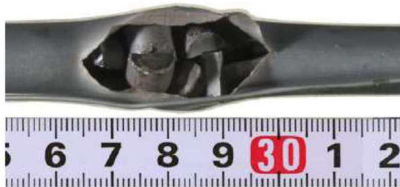
図 1 ハルデン炉試験で確認された FFRD 現象 [2][3]
