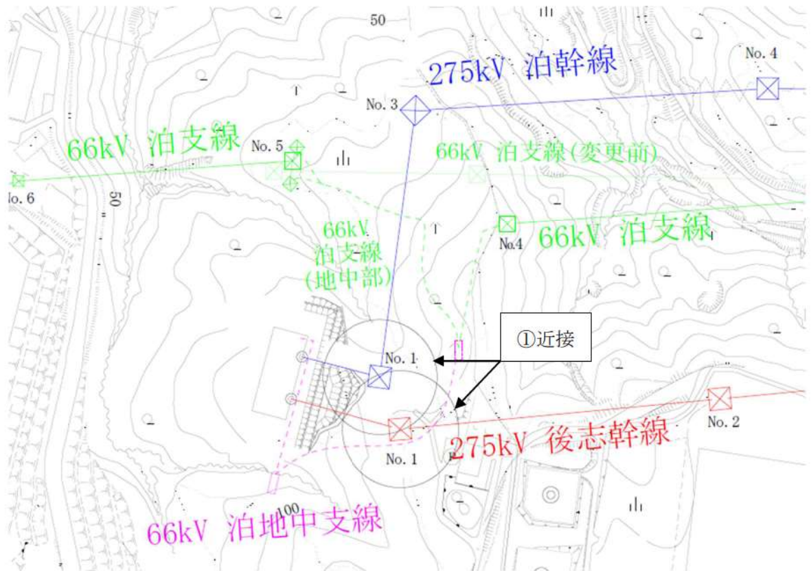
第 2. 2. 3. 3 図 ①近接箇所の現地状況 (3/3)
