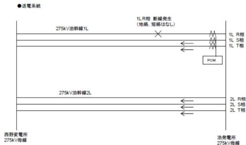
第 3.1 図 送電線保護装置による検知
