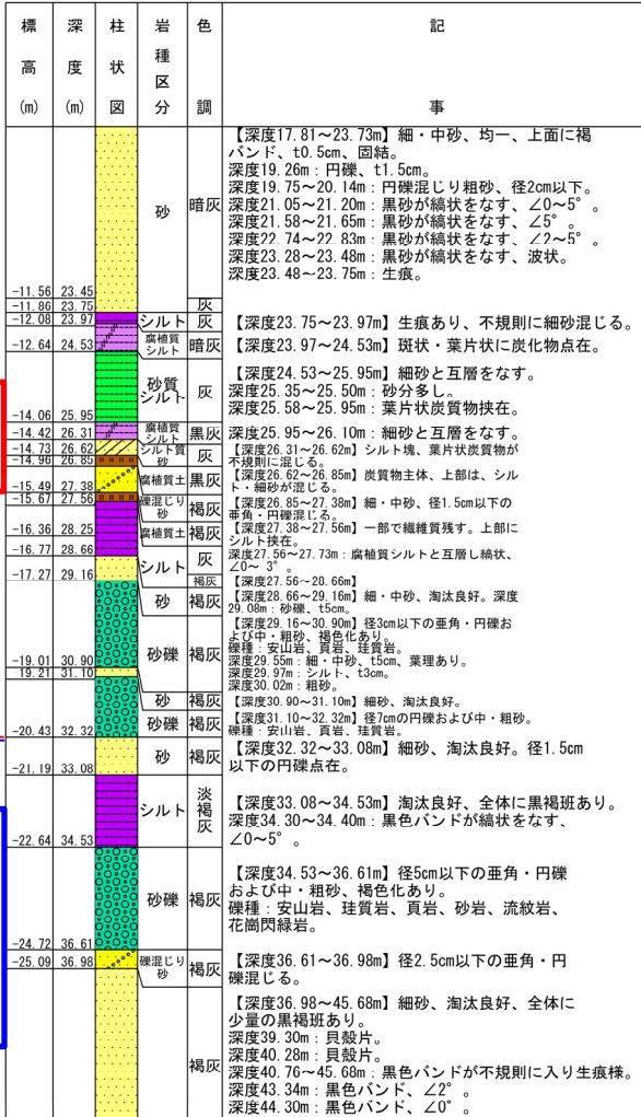
ボーリング柱状図(深度20~40m)
