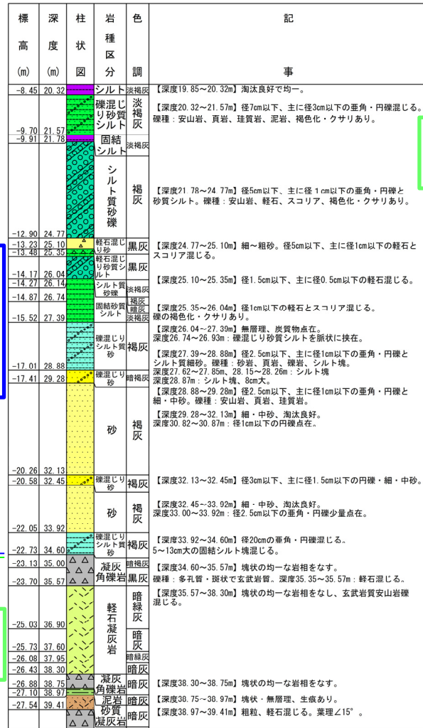
ボーリング柱状図 (深度20~40m)
