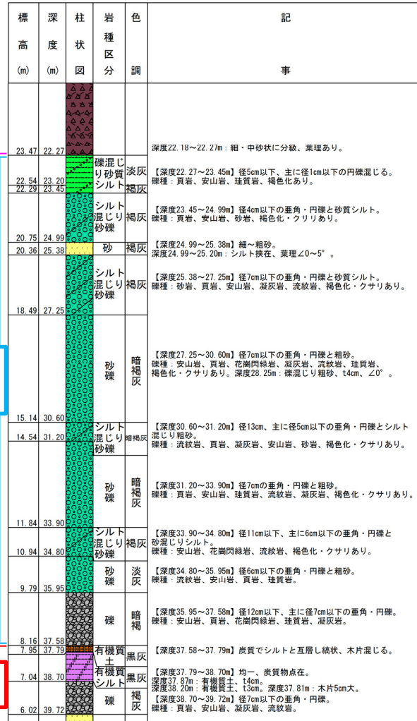
ボーリング柱状図 (深度20~40m)
