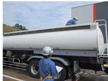
③タンクローリー上部の蓋開放 (タンク内の負圧防止措置)
