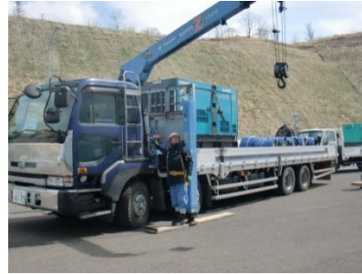
水中ポンプ及び駆動用 発電機搭載車両
