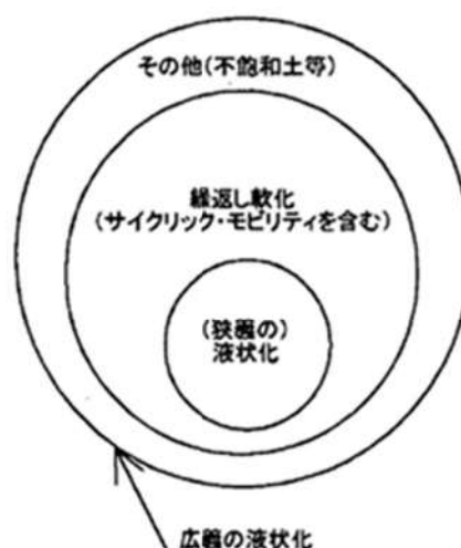
第 5.2-1 図 液状化に関連する言葉の定義 (土木学会地震工学委員会(2003)の報告書より引用)
