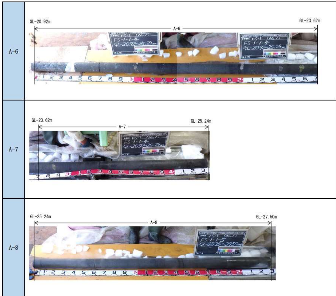
参考 1-24 図(4/10) ボーリング柱状図・コア写真 (FS-1)
