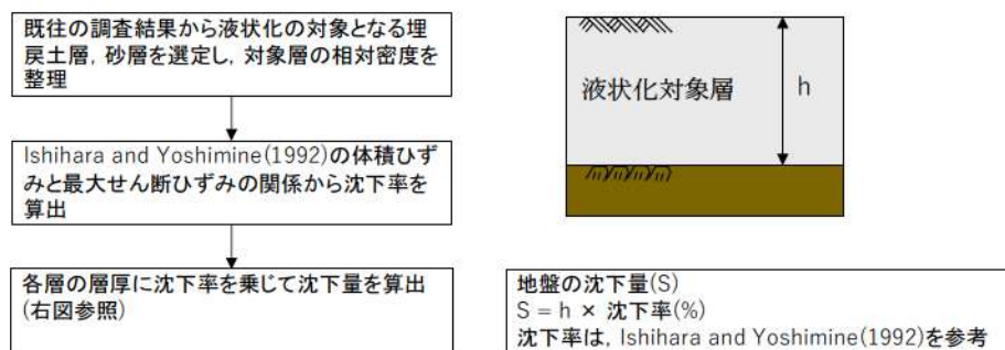
図4 飽和地盤における過剰間隙水圧消散に伴う沈下量の算定フロー
