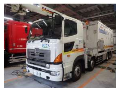
可搬型大容量 海水送水ポンプ車
