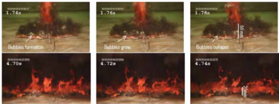
図 3.1-46 PULiMS-E4 試験での溶融物拡がり挙動
