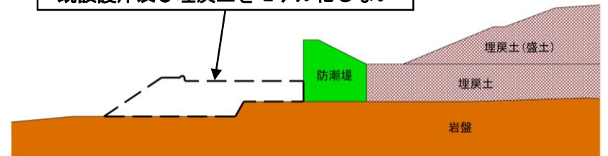
設置変更許可段階における構造成立性評価に用いる解析モデルイメージ
