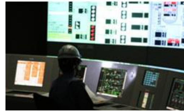
④運転訓練シミュレータ 事故時を想定し、急速に進展する事態に運転員が的確に対応できるよう、操作訓練を実施
